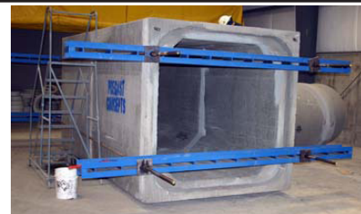
Dispositif de maintien typique, utilisant des poutres en acier et des tiges filetées à haute résistance à la traction.
